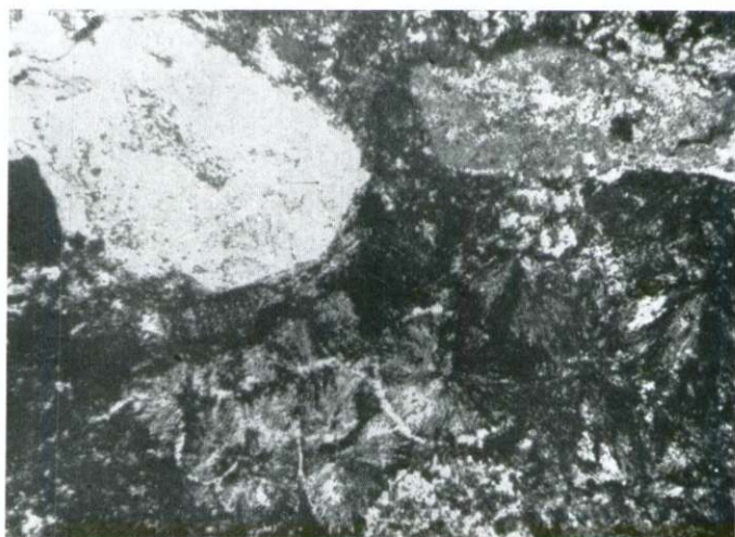
Sl. 5a in 5b, vz. 1116 c/12185, nikola || in +, 85 \times , Drmalka. Rdeč ignimbritni tuf. Sferuliti v fragmentu plovca. Dva velika, delno kalcificirana vtrošnika albita. V osnovi večinoma šibka kompresija
