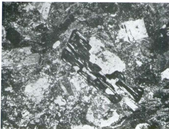
Sl. 9. vz. 1 116 b 1 /12—189, nikola +, 35 ×, Drmalka. Zelenkast ignimbritni tuf, sestavljen iz plovčevih fragmentov ter vtrošnikov albitiziranega in kalcificiranega plagioklaza. Vidimo tudi vtrošnik magmatsko korodiranega biotita. Osnova je sestavljena iz steklastih fragmentov in vulkanskega prahu, ki so delno kristalizirani in kalcificirani
