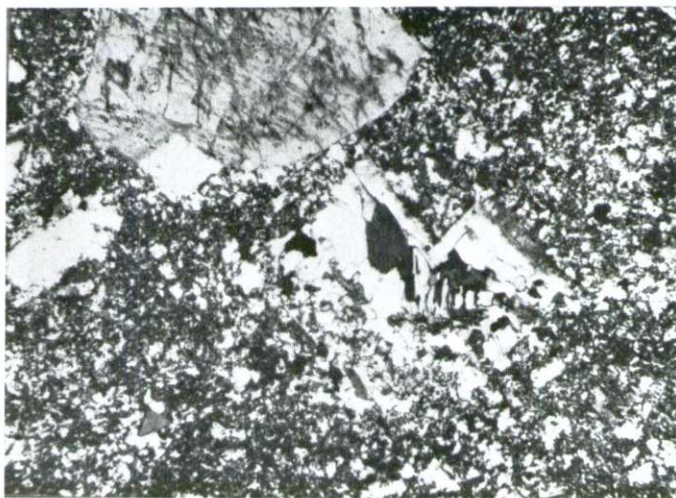
Sl. 3, vz. 1 454/11 748, nikola +, 35 \times , Tominčev graben. Rdeč ignimbradni tuf, devitrificiran, silificiran; plagioklaz, nadomeščen s kremenom in lamelicami kislega plagioklaza
