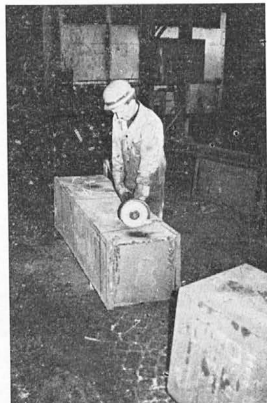
Bremena je treba vedno odlagati na stabilne in trdne podloge. Pri obdelavi ali predelavi materiala nestabilne podloške pogostokrat odpovedo in povzročajo peščodbe na nogah
