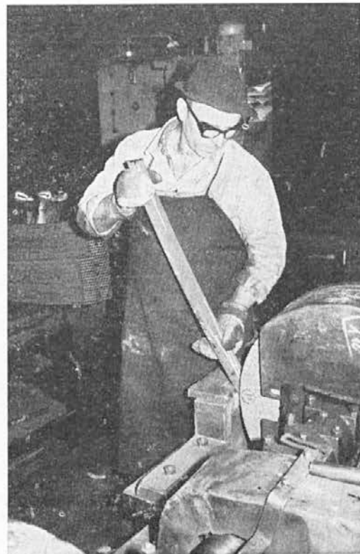
Pri določanju tehnoloških postopkov in pripravi dela je treba upoštevati varnostne normative. Nepravilen način brušenja vzmetnih listov na stabilnem brusilnem stroju je povzročil več obrusnin na prstih delavcev
