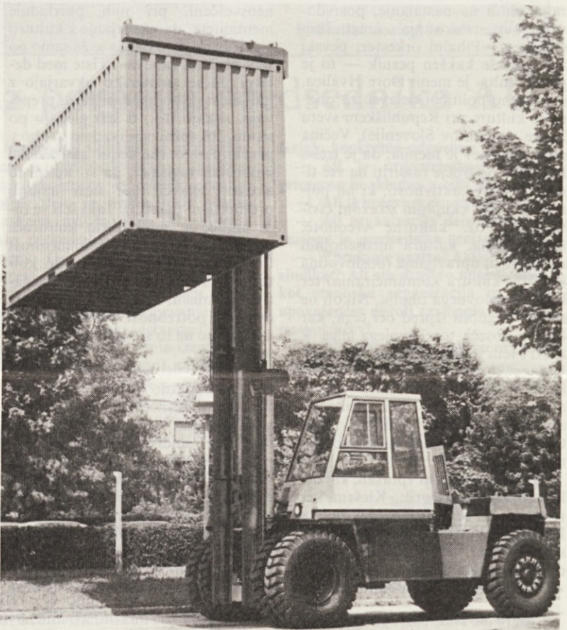
Viličar V25 KH P56 s tristopenjskim dvigalnim mehanizmom med preizkušanjem (Foto: B. Francelj)
