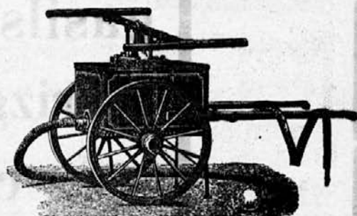
Dvokolna brizgalnica, podvojeno brizgajoča 180 — 200 2 /min.
