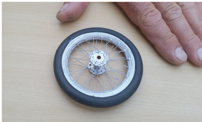
V samogradnji izdelano kolo s pestom iz aluminija, obročem iz vezane plošče in naperami iz najlonske vrvice
