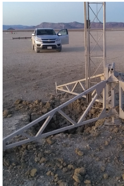
Krater, ki ga je izkopal izpuh motorja pri izstrelitvi večje rakete.
