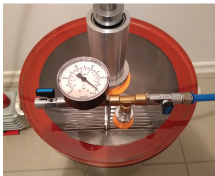
Doma izdelan vakuumski mešalnik za procesiranje raketnega goriva
