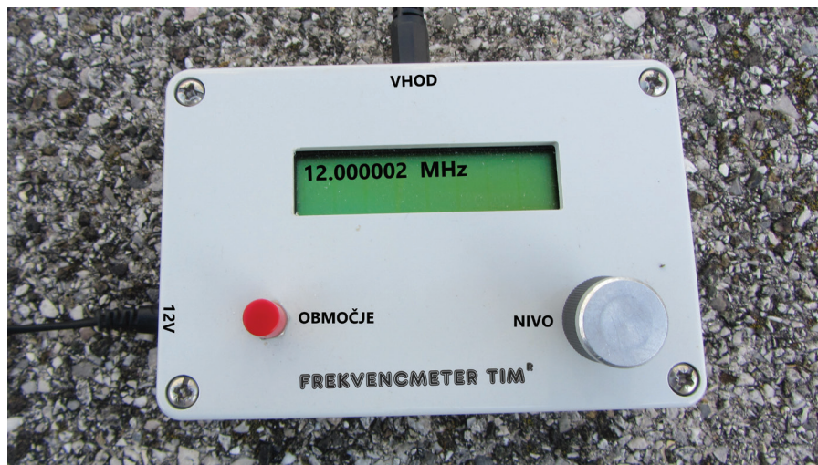
Zgornja frekvenčna meja Timovega frekvencmetra je 50 MHz.
