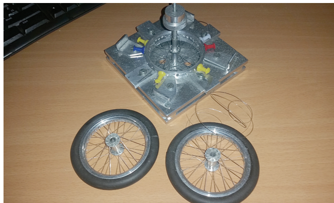
Različica kolesa s pestom, obročem iz aluminija in naperami iz ribiške vrvice. Na sliki je tudi šablona za sestavljanje teh koles.
