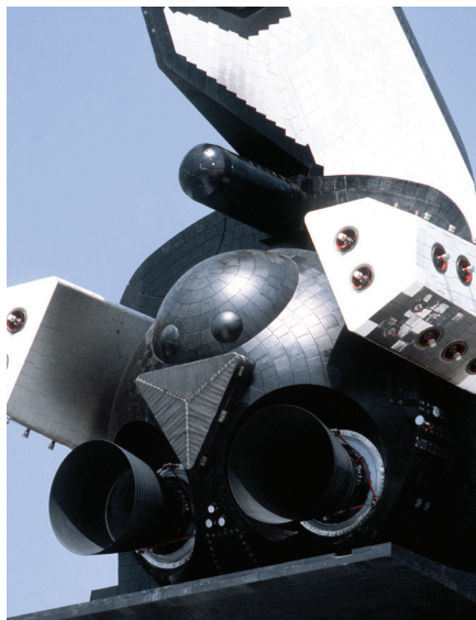
Pogled na repni del Burana, na katerem so lepo vidne črne in bele ploščice za toplotno zaščito, s katerimi je sicer prekrit celoten raketoplan. (Vir: internet)
