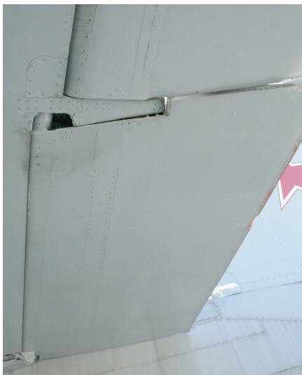
Zakrilca ob stiku s krmilom odklona na križu (Foto: Mitja Maruško)
