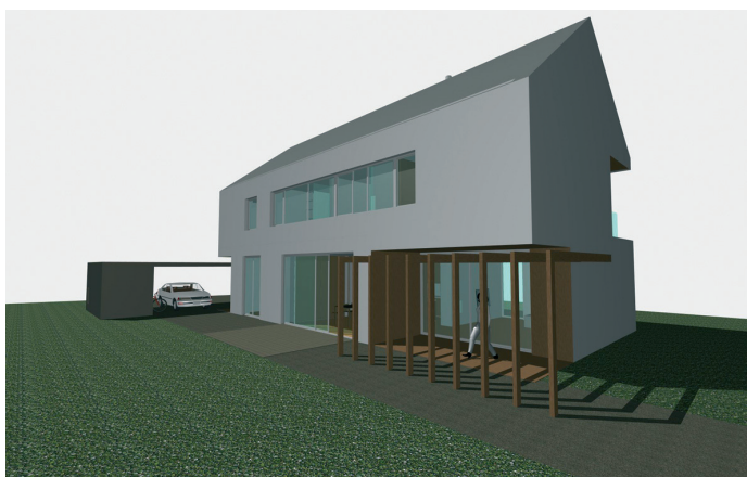
Slika 4: Model enodružinske hiše (P+1) s toplotno izolirano (d t.i.=24cm) temeljno ploščo.
