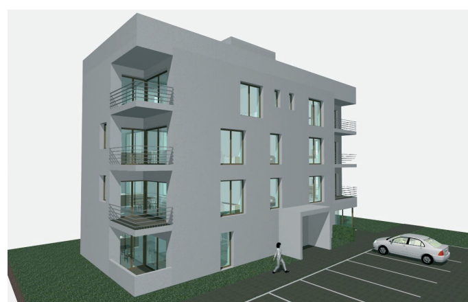
Slika 5: Model večstanovanjskega vilabloka (P+3) s toplotno izolirano (d t.i.=30cm) temeljno ploščo.
