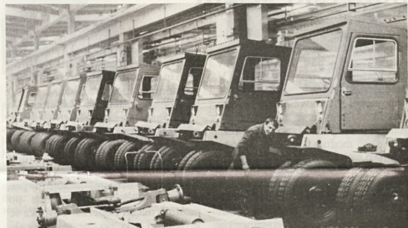
Serijski 8-tonski viličarji v montaži
