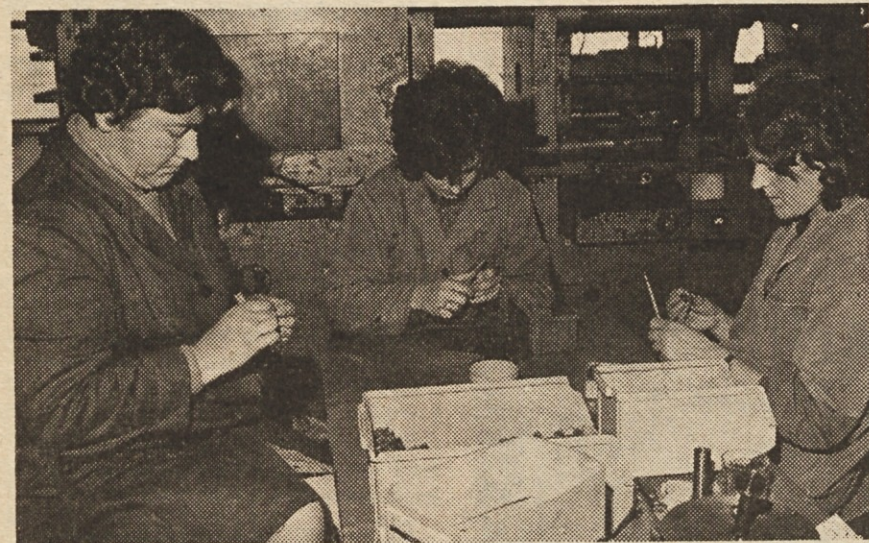
Čiščenje in kontrola bakelitnih odpreskov na Vrhniki.
