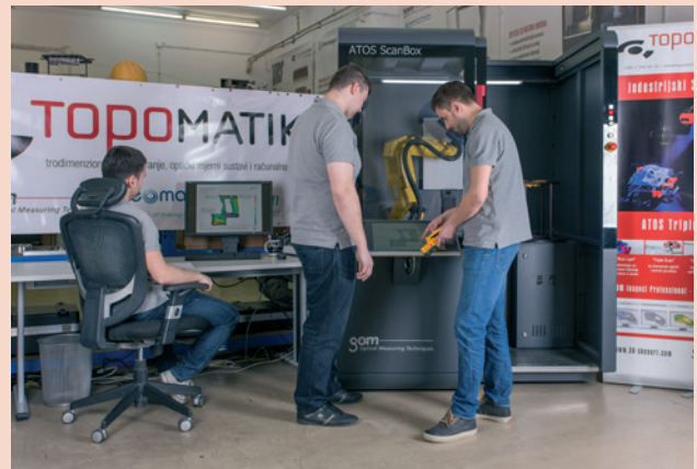
» V laboratoriju podjetja Topomatika se je vrsta študentov ob delu s strokovnjaki podjetja seznanila z najsodobnejšimi tehnikami 3D-merjenja in kontrole na robotskih merilnih postajah ATOS ScanBox nemškega proizvajalca GOM.
