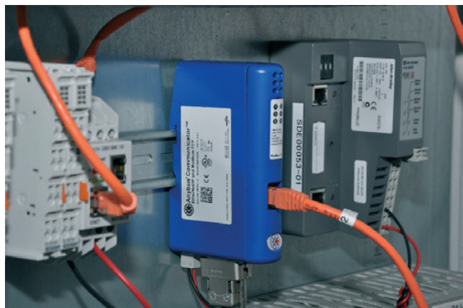
» Slika št. 1: Anybus Communicator je komunikacijski vmesnik namenjen povezovanju stroja in nadzornega omrežja.
