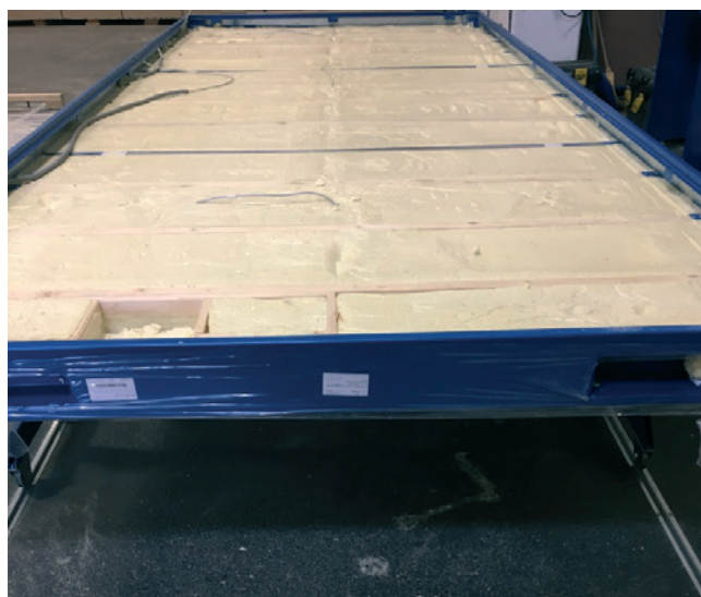
» Slika 5: Strop modularne enote z vlito poliuretansko izolacijo
