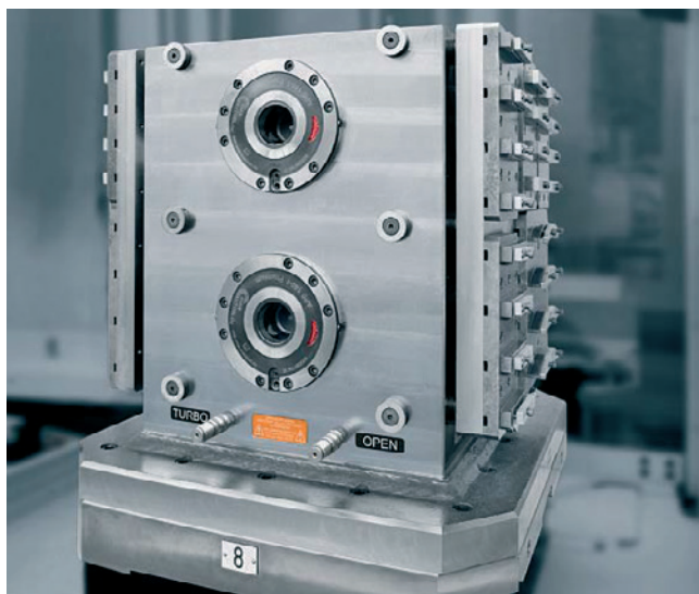
» Vpenjalni steber, opremljen z vpenjalnim sistemom z ničelno točko, je zelo učinkovita rešitev.
