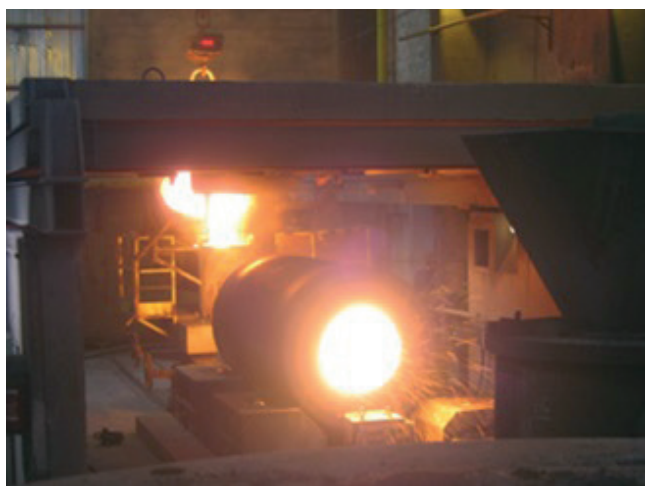
» Slika 2: Centrifugalno litje plašča HCS valja [3]
