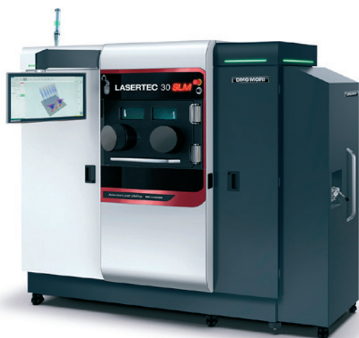
» LASERTEC 30 SLM: DMG MORI je z večinskim deležem v podjetju REALIZER GmbH iz Borchna razširil svoje kompetence na področju dodajalne izdelave kovinskih tehnologij s tehnologijo selektivnega laserskega taljenja, dobavili pa so že tudi prve stroje.
