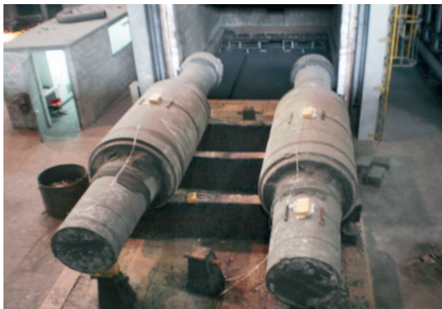
» Slika 5: Namestitve termoelementov na valju
