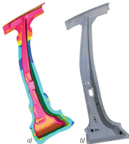
» Slika 5: B-stebriček avtomobila izdelan s preoblikovanjem pločevine v vročem; a) simulacija, b) izdelan B-stebriček
