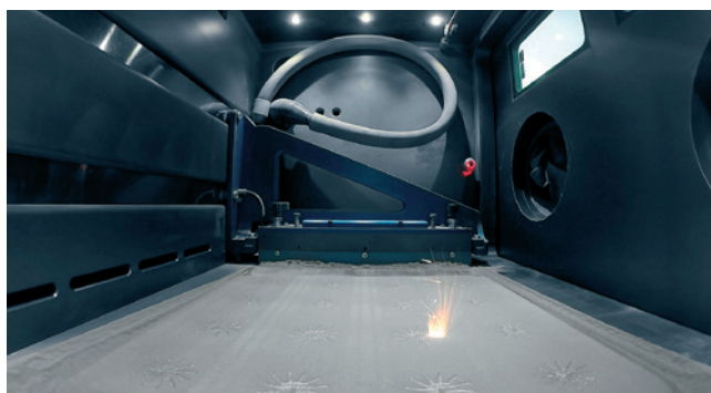
» Delovna prostornina stroja LASERTEC 30 SLM meri 300 × 300 × 300 mm, največja nosilnost pa je 200 kg. Menjava prahu traja samo dve uri.
