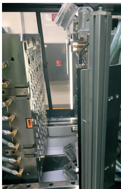
» Slika 2: Leva slika prikazuje integracijo sistema MOLDEYE INSPECTOR v kritične pogoje proizvodnega procesa, ki bo natančneje predstavljen v prihodnji izdaji revije. Desna slika pa prikazuje t. i. pametne kamere DATALOGIC.
