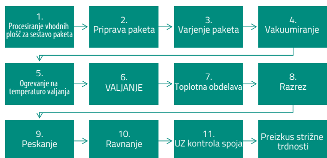
» Slika 2: Tehnološki koraki v proizvodnji platinirane pločevine.
