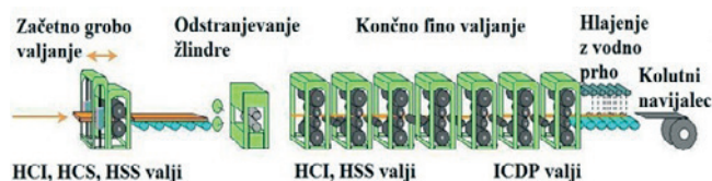
» Slika 1: Valjarniška proga z razporeditvijo valjev [1,2]
