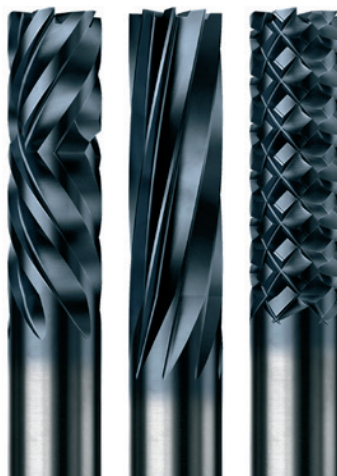
» V seriji CoroMill® Plura so trije rezkarji za obdelavo kompozitnih materialov: CoroMill Plura s stisnjenima vijačnicama, CoroMill Plura z nizko vijačnico in nazobčani CoroMill Plura
