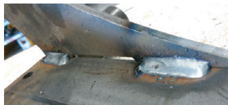
» Slika 4: Varjenje z zaščitnim plinom Ar + 18 % \text{CO}_2
