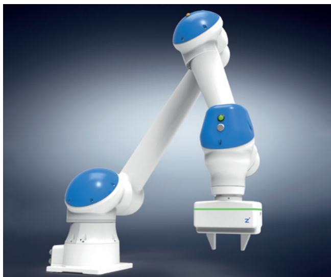
» HRC prijemalo za robote YASKAWA iz serije MOTOMAN HC10 in GP.
