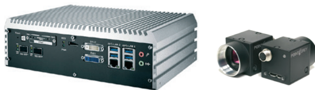
» Slika 4: Prikazuje zunanji industrijski računalnik, na katerega se priklapijo kamere, svetila, ekran itd.
