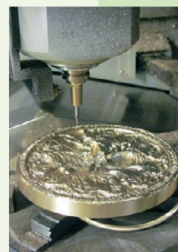
» Sodick mc 430L: Mikrofrezanje je definirano kot zmanjševanje skale klasičnega procesa frezanja, ki vključuje uporabo premera frezal v podmilimetrovskem področju.
