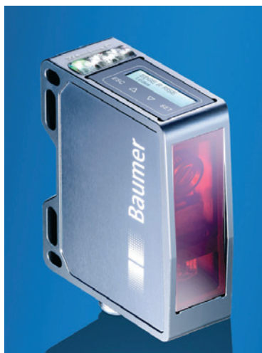
» PosCon 3D iz Baumerja lahko zazna rob objekta, nato pa meri njegovo širino v delčkih sekunde z natančnostjo 0,02 mm – ne glede na orientacijo.
