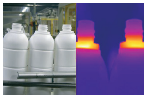
» Slika 1: Leva slika prikazuje napako, ki je zaznana s sistemom MOLDEYE INSPECTOR in je ob tako veliki količini izdelkov v embalaži praktično ne moremo zaznati. Sredinska slika prikazuje merjenje nivoja tekočine v embalaži, desna slika pa prikazuje temperaturno meritev vratu embalaže.
