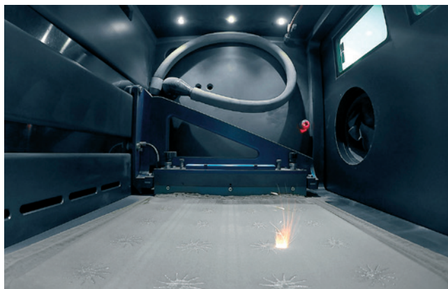
» Stroj LASERTEC 3D SLM ima delovno območje veliko 300 x 300 x 300 mm.
