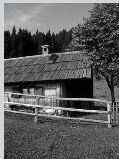
□ Slika 3. Velik napušč na izpostavljeni strani ščiti fasado pred padavinami
