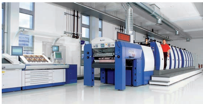
Nova KBA Rapida 105 je prva v generaciji ofsetnih strojev, ki lahko obojestransko tiskajo pri hitrosti 18.000 od./uro. V Delu tiskarni so pognali desetbarvni stroj, ki omogoča petbarvni obojestranski tisk (5 + 5).
