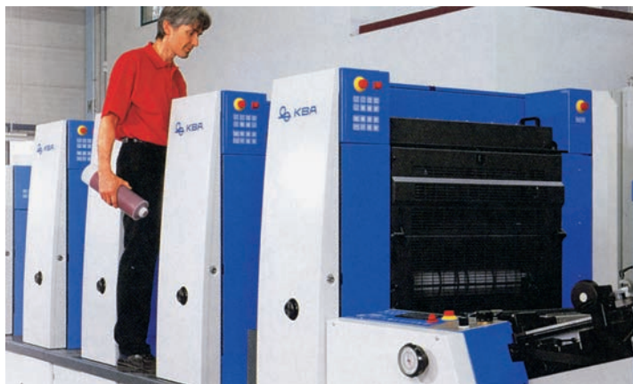
Slika 6. Drugo nagrado za inovacije v grafični dejavnosti so dodelili ofsetnemu stroju KBA Rapida 74 G (prvo si je prislužil I-papir, opisan v prejšnji številki, tretjo pa Spectrodens). Stroj ima mnogo posebnosti, najpomembnejša pa je barvni sistem GravufLOW z rastrskim valjem, barvno komoro (rakelj in nož), zato brez conskega upravljanja nabarvanja tiskovne forme.
