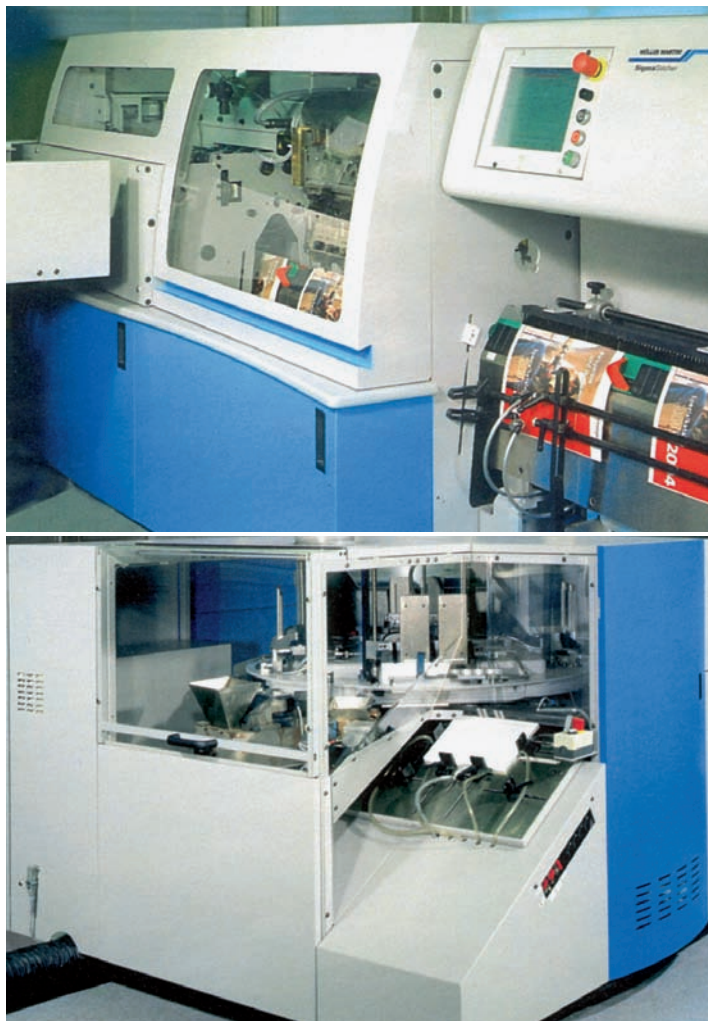
Slika 9. Revijalka oz. znašalno-šivalni stroj Sigma Sticher (zgoraj) in stroj za lepljeno vezavo Sigma Binder (spodaj) sta srce knjigoveške linije Sigma Line.
