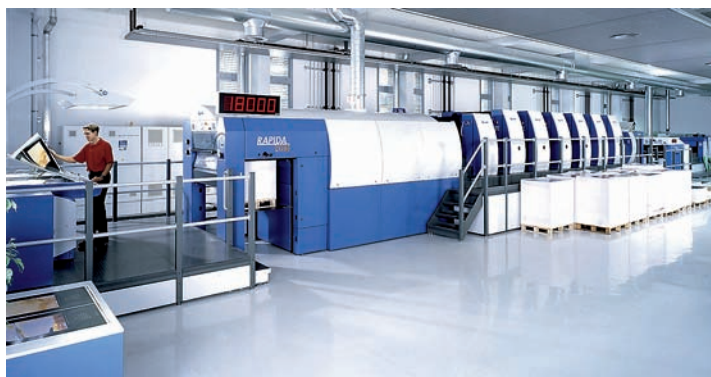
Nova KBA Rapida 105 je prva v generaciji ofsetnih strojev, ki lahko obojestransko tiskajo pri hitrosti 18.000 od./uro. V Delu tiskarni so pognali desetbarvni stroj, ki omogoča petbarvni obojestranski tisk (5 + 5).
