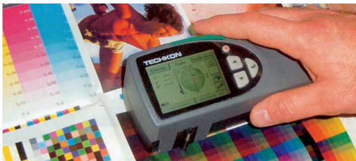
Slika 5. Spectrodens v uporabi: ergonomska uporaba in pregledno razporejeni elementi za upravljanje so bili pri razvoju, kakor zagotavlja proizvajalec, prav tako pomembni kot kratki merilni časi in pregledno podajanje meritev na zaslonu.
