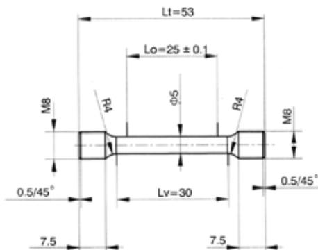
**Figure 4:** Tensile round bar specimen B 5 × 25
