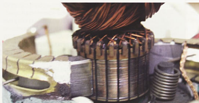
Slika 5: Test življenjske dobe pri eni izmed variant polkrožnih ščetk
