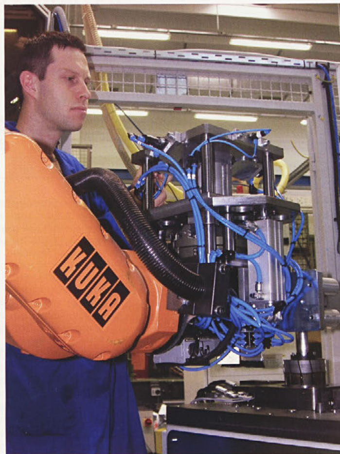
Šestosni robot za posluževanje izoliranja paketov motorjev serij 767, 768 in 769
