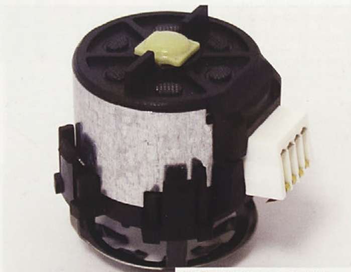
Koračni motor za pozicioniranje odbojne plošče radarskega senzorja
