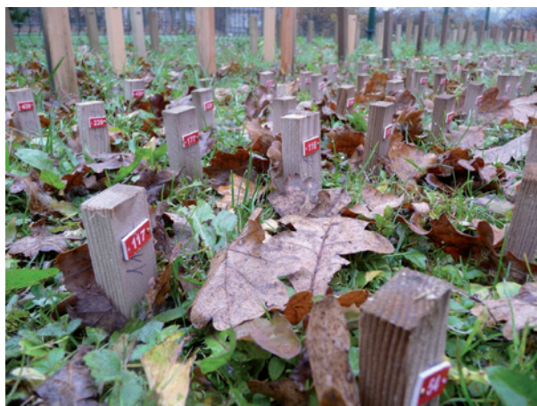
Slika 2. Vzorci, izpostavljeni v 4. razredu uporabe na terenskem polju Oddelka za lesarstvo
