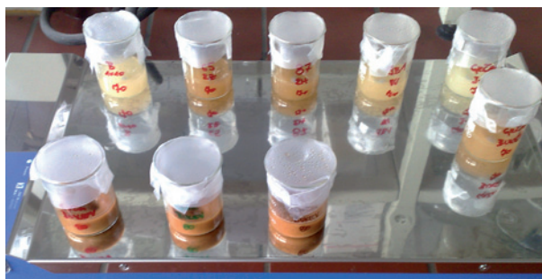
Slika 3. Ekstrakcija s 70 % metanolom (aq) na večmestnem magnetnem mešalu
