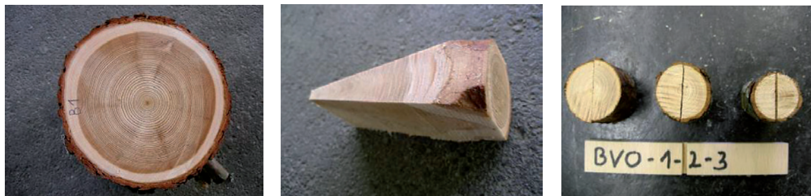
Slika 1. Vzorci lesnih tkiv na višini 13 m (beljava, jedrovina, grča, segmenti veje)
