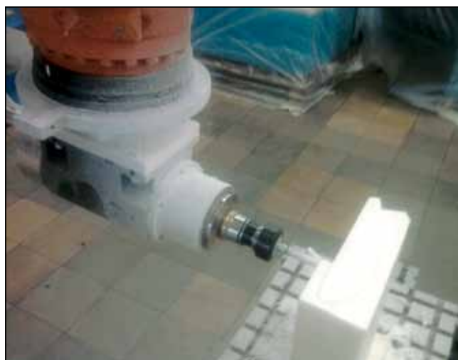
Slika 5. Freziranje obdelovanca lopatice
