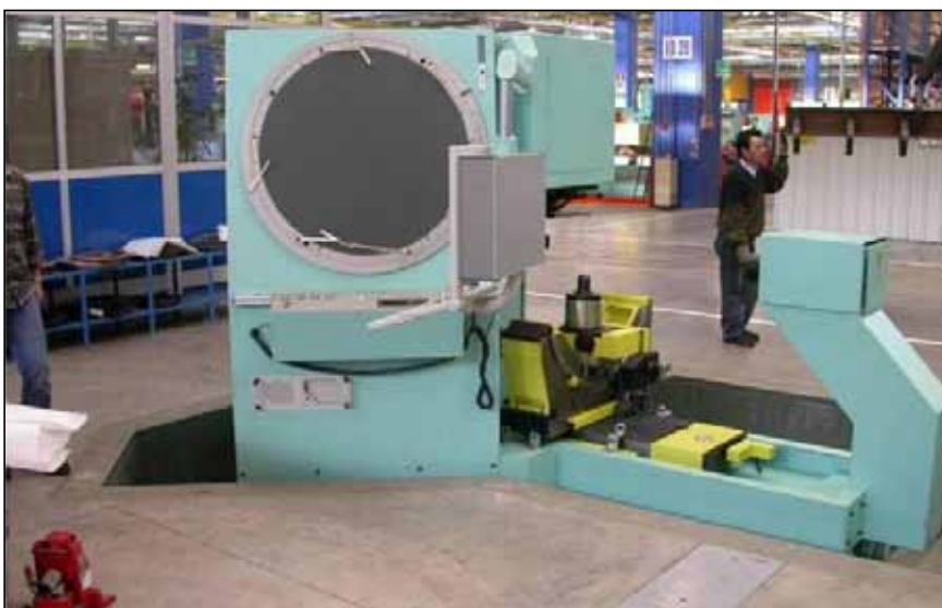
Slika 3. Postavitev profila projektorja po naročilu podjetja Avio. Posebnost tega stroja je njegova vgradnja v betonske temelje za večjo točnost.
