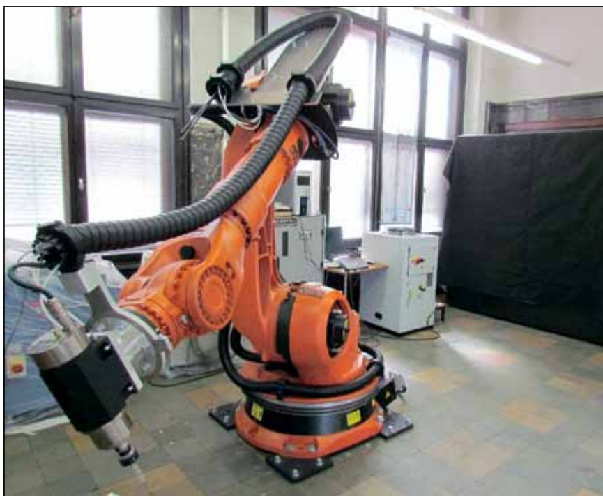
Slika 1. Robotska celica s komponentami in frezalno glavo
