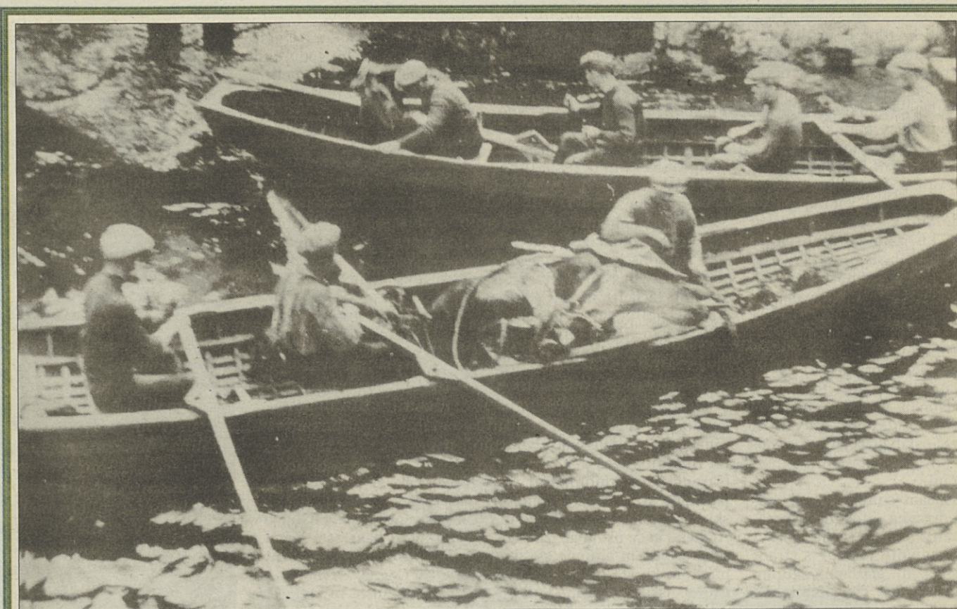
Edina zveza z Irsko so bili veliki čolni: leseno ogrodje, prekrito s platnom in premazano s katramom
