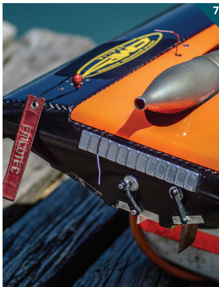
Natančna nastavitev težišča modela z dodajanjem ali odvzemanjem uteži
