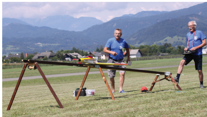
Štart modela letala s pulzoreakcijskim motorjem. Model naj bi vzletel s štartne rampe s pomočjo elastike in nato nadaljeval let s svojim pogonom.
