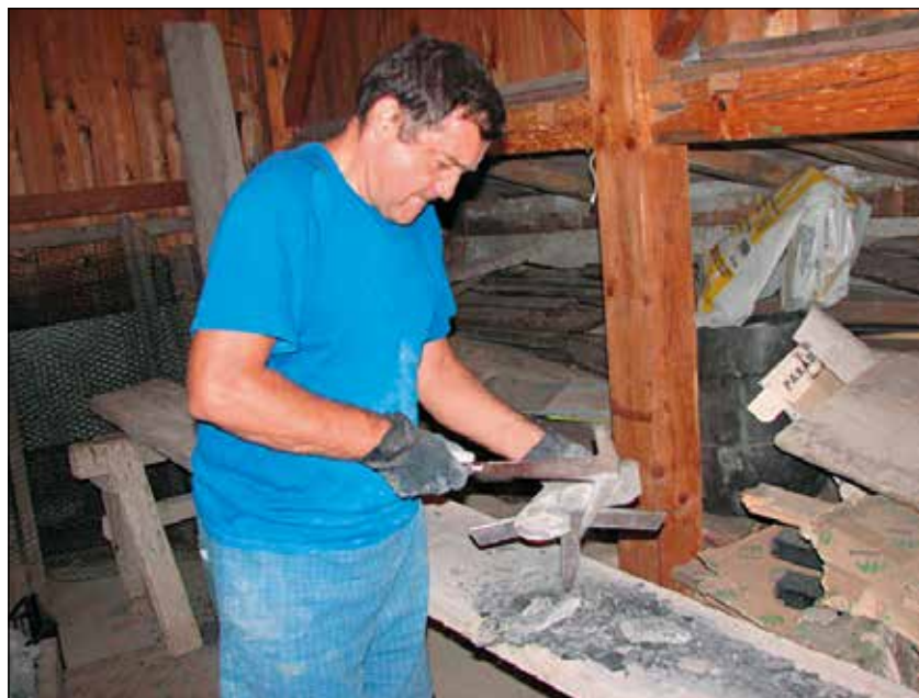
Klesanje skrilnih ploščic. Foto: Arhiv družine Ferlan
