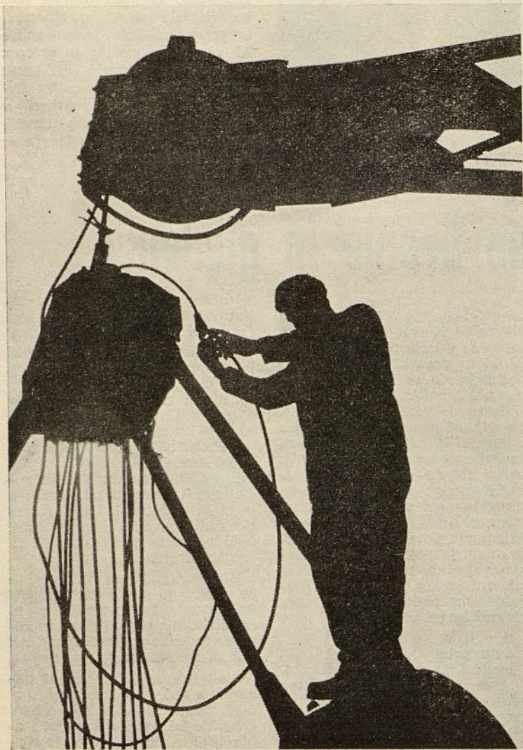
Spajanje vrvi na grabežu tirnega dvigala »demag«
