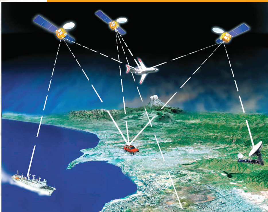
GPS-sprejemnik v avtomobilu, letalu ali na ladji sprejema signal več satelitov in preračunava lego z izjemno natančnostjo.
