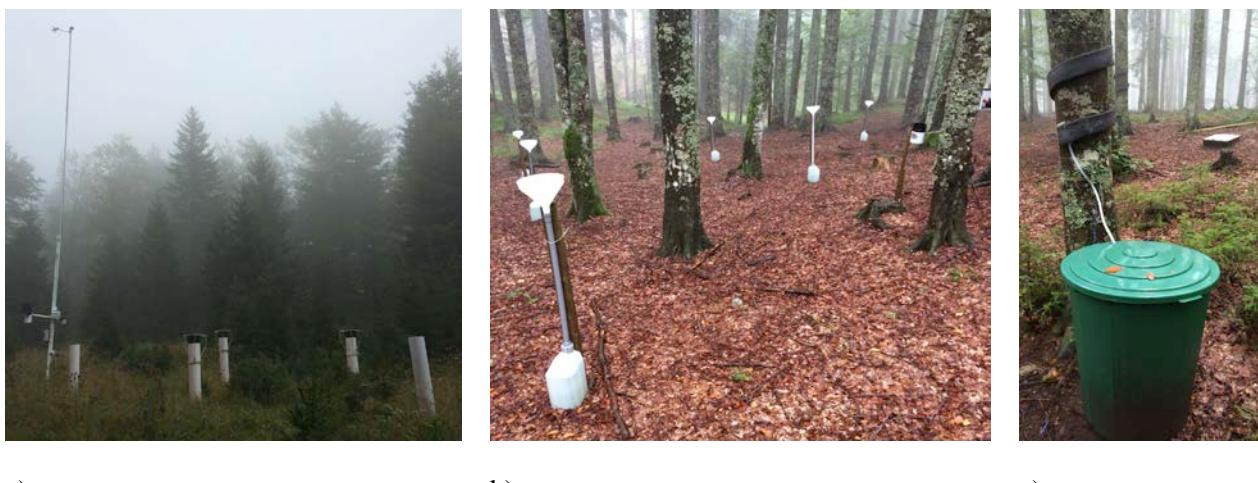
**Slika 3:** Meritve a) padavin na prostem, b) prepuščenih padavin in c) odtoka po deblu na ploskvah v eksperimentalnih porečjih Javorškega potoka in Lukanijskega potoka v zgornjem porečju Oplotnice na Pohorju (foto: Kestnar, 2014).
