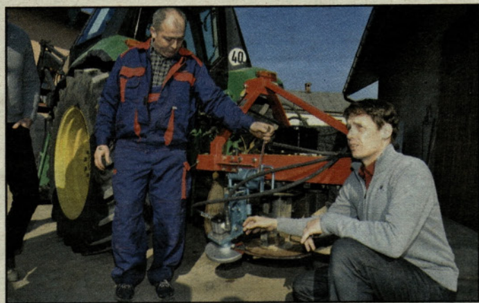
Jani Basle med predstavitvijo delovanja stroja za obrezovanje hmelja
