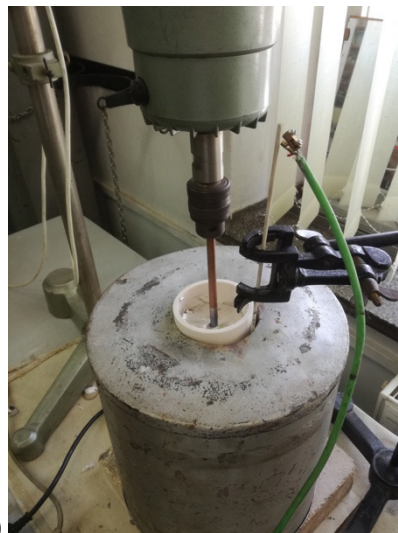
Sl. 1. Shematski prikaz vzorca orodnega jekla (a) in laboratorijske naprave za določanje interakcije med orodnim jeklom in tekočim aluminijem (b)
