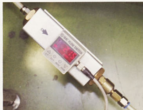
Prikaz meritev porabe električne energije in stisnjenega zraka pri proizvodnih procesih
