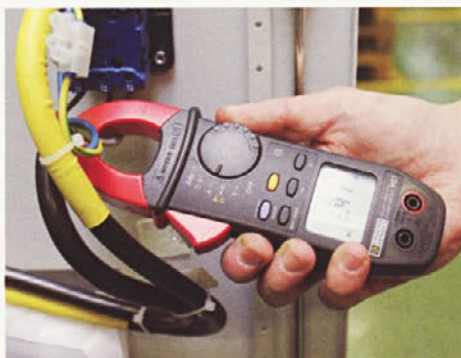
Prikaz meritev porabe električne energije in stisnjenega zraka pri proizvodnih procesih
