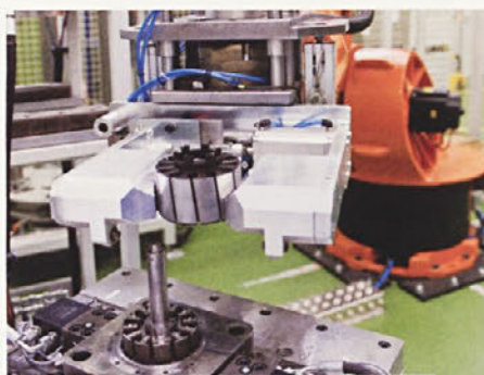
Robotska celica za nabrizgavanje izolacije
