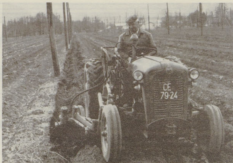
Diskovni odkopalnik-osipalnik je posebno uspešen za spomladansko obdelavo robnih vrst in vrst z drogovi
