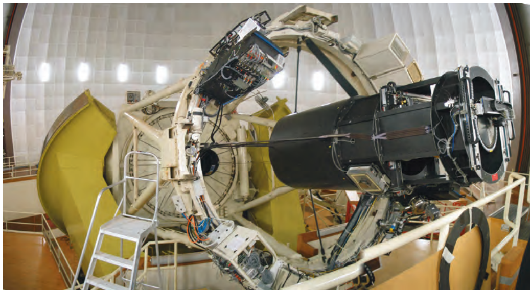
Dnevni posnetek štirimetrskega teleskopa na observatoriju v Siding Springu v Avstraliji. Svetloba vpada z desne, se odbije na (pokritem) primarnem zrcalu in nato zbere na hrbtni strani črnega valja, kjer je plošča z optičnimi vlakni. Noben drug teleskop take velikosti nima kar dve stopinji širokega vidnega polja, kar omogoča, da bomo v okviru projekta Hermes/GALAH z njim posneli visoko ločljive spektre milijona zvezd, razporejenih po vsem južnem nebu. Foto: Tomaž Zwitter.
