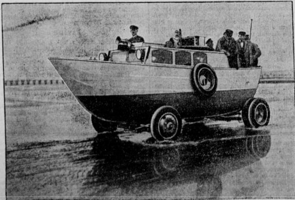
Avtomobil in motorni čoln, ki ga je izdelala tvrdka v Cuxhavenu za državo. Vozilo drči po suhem kot avto, v vodi se spremeni v motorni čoln.
