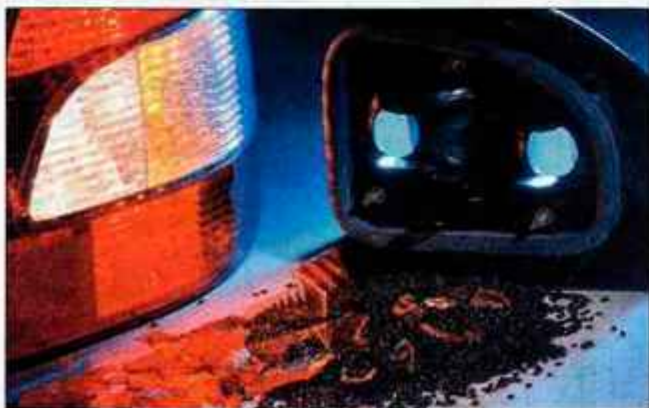
Iz reciklirane avtomobilске luči nastane granulát, ki ga je mogoče ponovno uporabiti za izdelavo plastičnih delov avtomobila.
