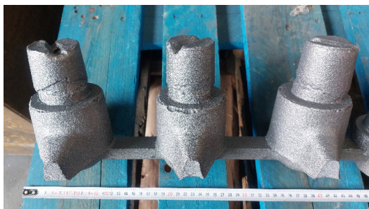
Slika 8. Detajl napajalnikov po peskanju. Desno, ostanek materiala iz klasičnega vložka 6/9. Levo, ostanek materiala iz vložka CHEMEX EK 50/80 T.
