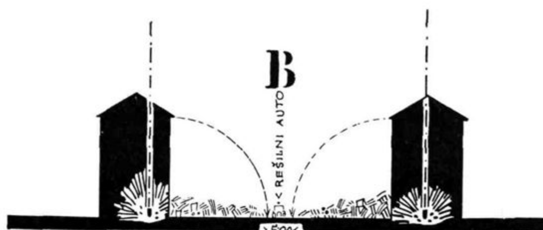
Posledica zračnega napada: A v ozkih ulicah zasužejo podrtine ceste in je reševanje otežkočeno, B v ulicah, ki so vsaj za 5 metrov širše od obeh višin obcestnih zgradb, ni zaprta pot rešilnemu avtomobilu in reševalcem
