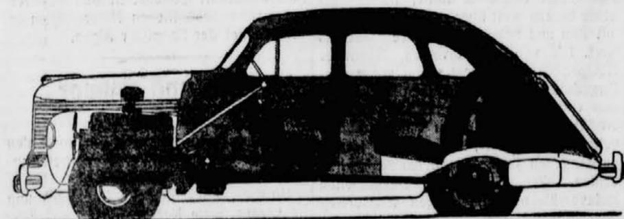
Die selbsttragende Ganzstahlfarsserie des neuen Opel Kapitän ermöglicht eine bisher unerreichte Raumaussnutzung: der Motor liegt weit vorn über der Achse — dadurch ist fast der ganze Raum zwischen den Achsen für die Insassen voll ausnützlich. Die Hinterstühle liegen fast 1/2 m vor der Hinterachse im bestgelegerten Raum. Diese Anordnung schafft einen Gepäckraum von überraschender Größe. Die Unterbringung der Koffer bei einer Serienreihe von 4 Personen ist kein Problem.
