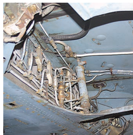
Notranjost kolesnih prostorov je dobro ohranjena, saj so celo usnjene manšete, ki ščitijo dostope v notranjost strukture letala, cele in nepoškodovane. Čeprav je letalo na videz dobro ohranjeno, bo pravo oceno stanja lahko podala le strokovno usposobljena oseba. Foto: Tomaž Perme
