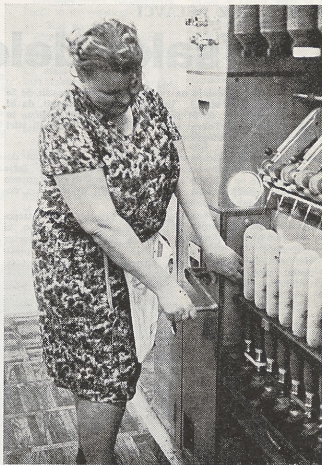
Predica pripravlja krušikov prstančni stroj za snem. Kljuka ni bila dobro zapeta in je že večkrat udarila predico. Na sliki je predica prikazala, kako deluje varovalka, ki se je pri nekaterih strojih izrabila
