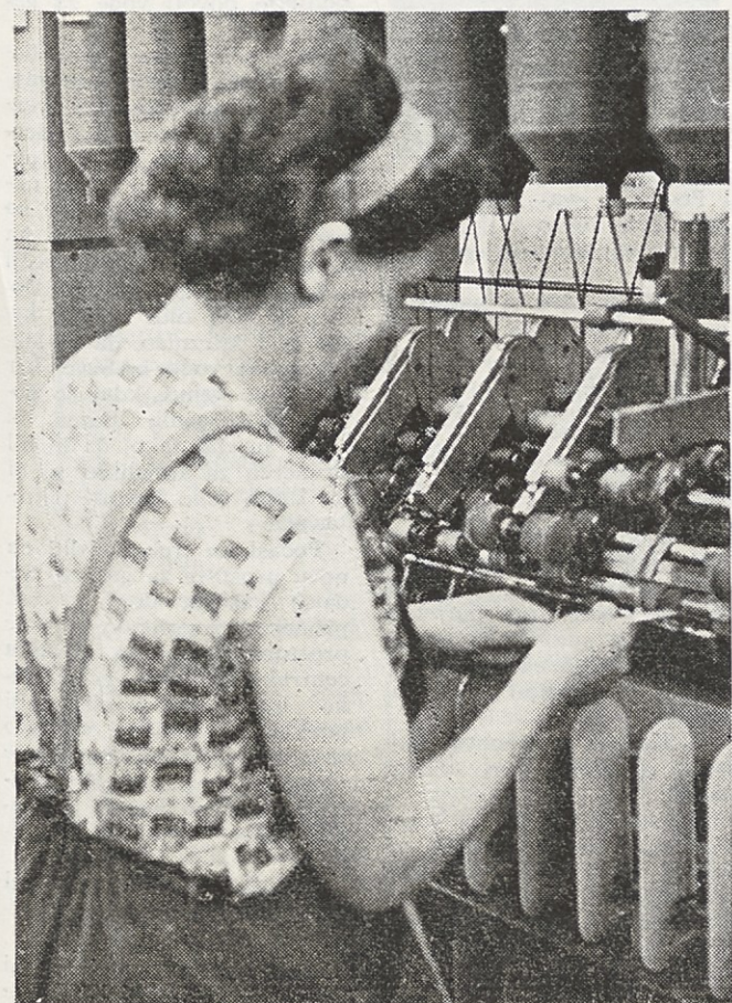
Odstranjevanje navite preje z medeninasto kljukico — več predic, ki že leta delajo na prstančnih strojih se je zadnje čase poškodovale
