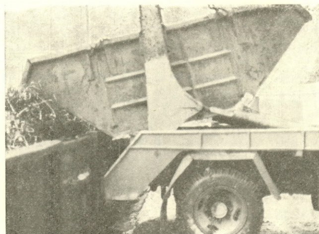
Detajl razkladanja na železniški nakladalni rampi v Trbovljah. Kontejnerski koš zadene v stranico vagona
