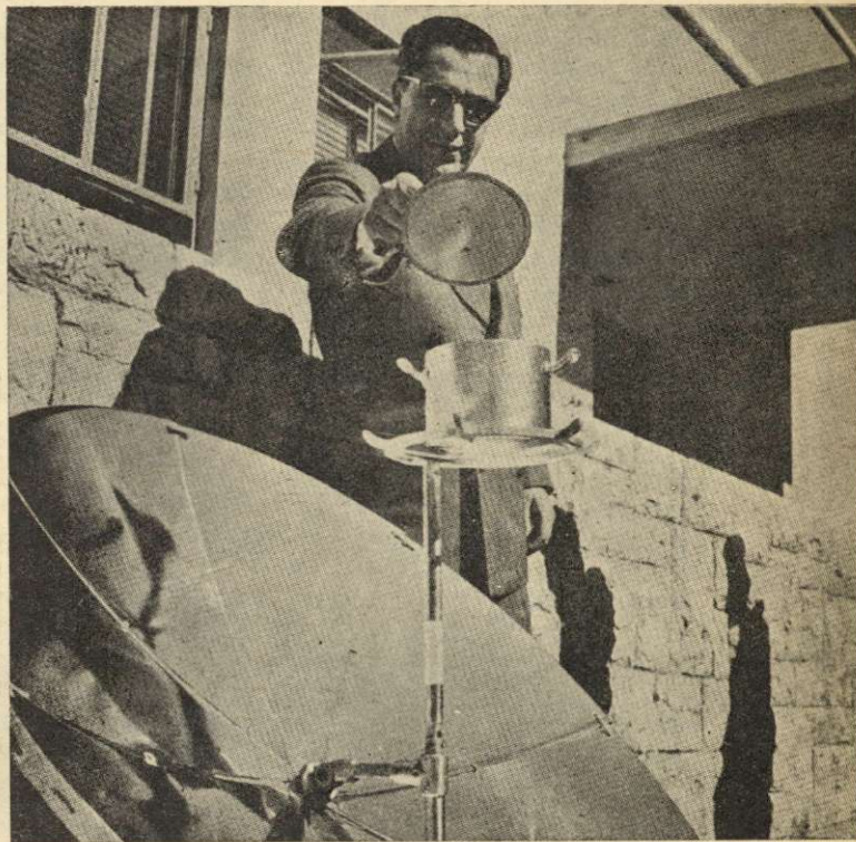
Slika 2. Sončni kuhalnik. Na spodnji levi strani slike je vidno zbiralno zrcalo
