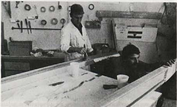
Izdelava nosilcev krila jadralnega letala
