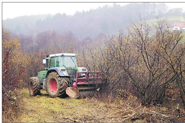
Stroj se lahko loti tudi še rastočega drevja in grmovja
