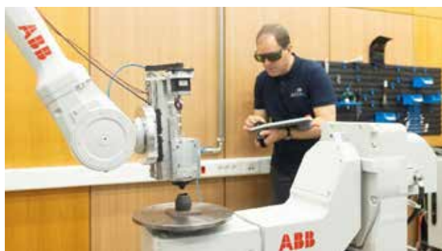
Slika 1 : Robotizacija procesa laserskega usmerjenega nanašanja (nadgradnja) (Foto: IFP, d. o. o.)
