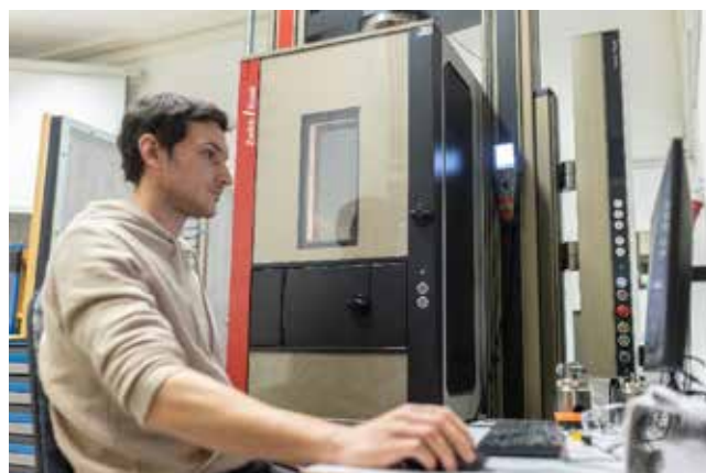
Slika 2 : Aktivna računalniško krmiljena temperaturna komora, kompatibilna z univerzalno napravo za preizkušanje materialov (Foto: IFP, d. o. o.)
