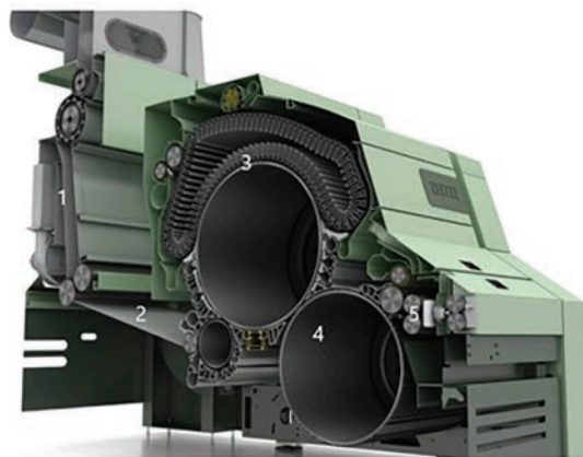
Slika 7: Mikalnik C77: 1 – volumetrični napajalnik mikalnika, ki omogoča enakomerno napajanje kosmov in kosmičev, 2 – dovajalni trak, kjer se tvori enakomerno runo, 3 – pokrovčki in mikalni boben, 4 – snemalni valj, 5 – par odvajalnih valjev [5]
