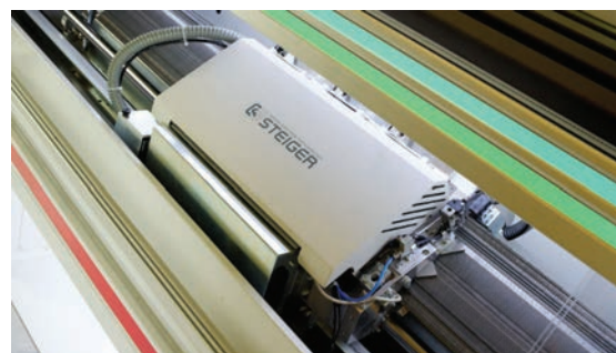
Slika 6: Odprte sani pletilnika Steiger Antares 2.185 (vir: https://steiger-textil.ch/project/antares-2-185-e3/ )
