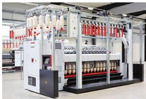
Slika 22: Prikaz krilnika AutospeedM izdelovalca Saurer: 1 – avtomatski transport praznih cevk in navitkov stenja, 2 – raztezalo (trivaljno dvojeremenčno raztezalo), 3 – voz z navitki stenja [9]
