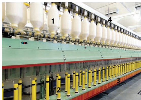
Slika 23: Prikaz krilnika FT6E izdelovalca Marzolija: 1 – navitki stenja, 2 – prazne cevke, 3 – voz, na katerem so nameščene prazne cevke, 4 – viseči transport navitkov stenja [10]
