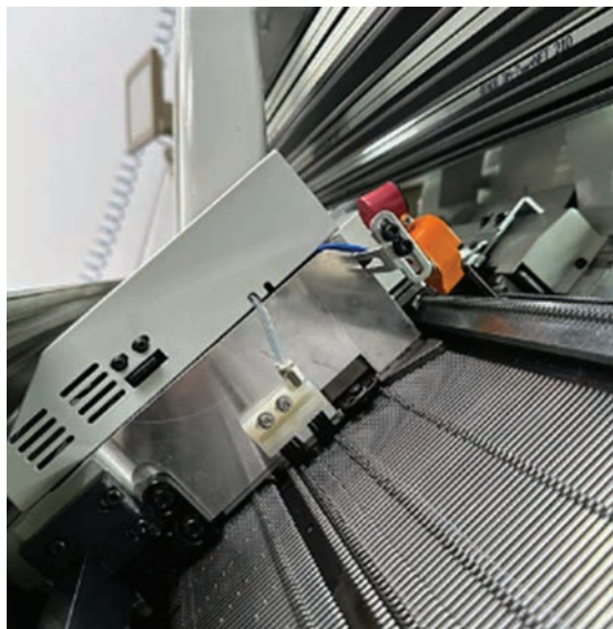
Slika 7: Pametne sani – pletilnik Mandarin (vir: https://www.mandarinkt.com/en/tecnologia-syf )
