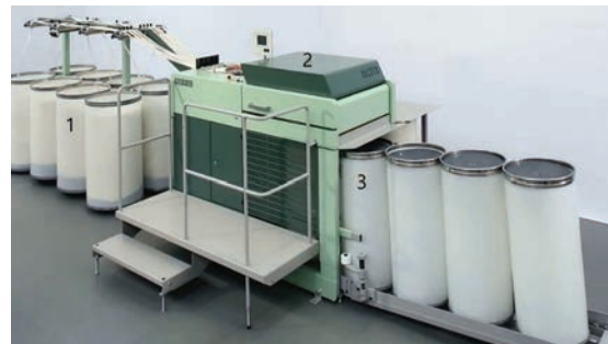
Slika 14: Valjčni raztezalnik RSB D55: 1 – združevanje pramenov iz loncev pred raztezanjem, 2 – trivaljno raztezalo, 3 – lonec z raztezanim pramenom [7]
