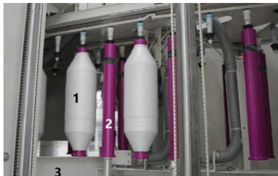
Slika 20: Prikaz bikonusnih navitkov in praznih cevk na krilniku F40: 1 – bikonusni navitek predpreje, 2 – prazna cevka, 3 – voz z navitki [7]
