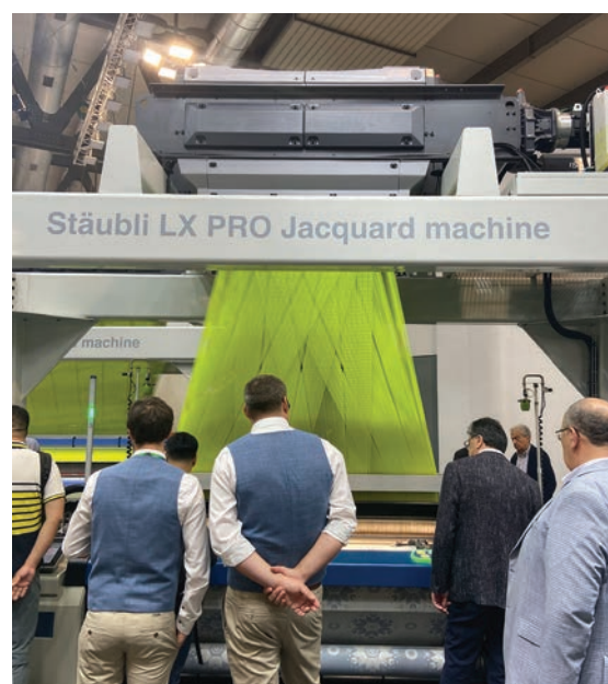
Slika 6: Žakarski stroj LX PRO [8]
