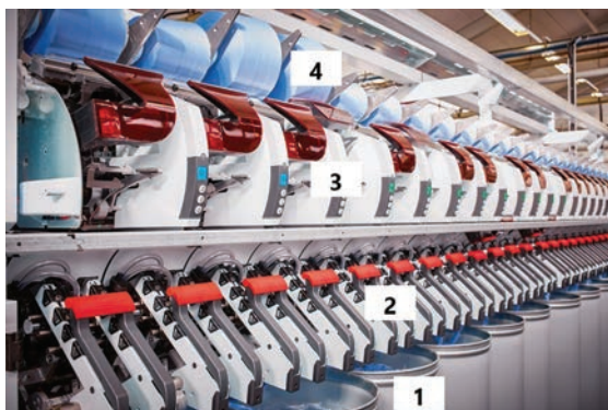
Slika 29: Curkovni predilnik Autoairo: 1 – lonec s pramenom; 2 – trivaljno dvojermenčno raztezalo; 3 – čistilec preje; 4 – križni navitek [12]
