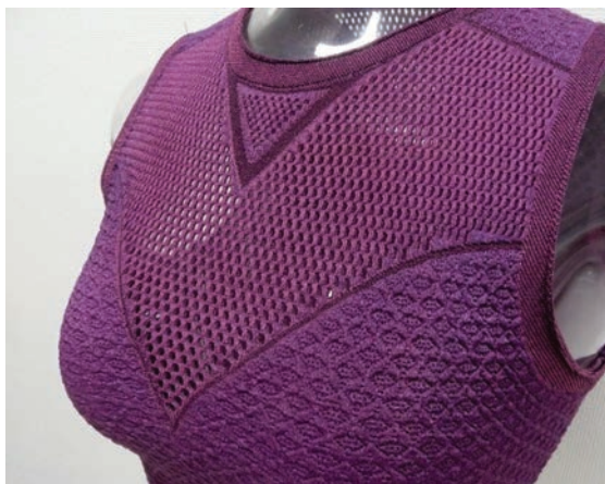
Slika 10: 4D-pletivo, izdelano na pletilniku Karl Mayer (vir: https://www.gesamtmasche.de/news/karl-mayer-4d-knit-mit-neuen-moglichkeiten/ )
