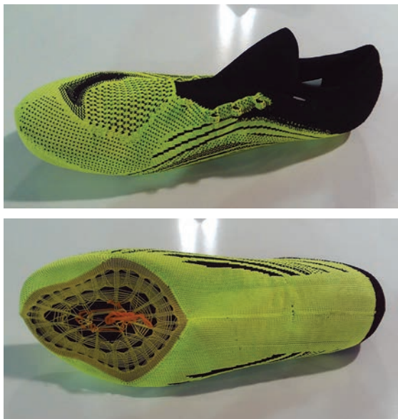
Slika 15: Colosio – napleteni zgornji deli športne obutve (foto A. Pavko Čuden)
