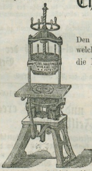
Teigtheilungs- od. Aufgebemaschine für Bäcker.
