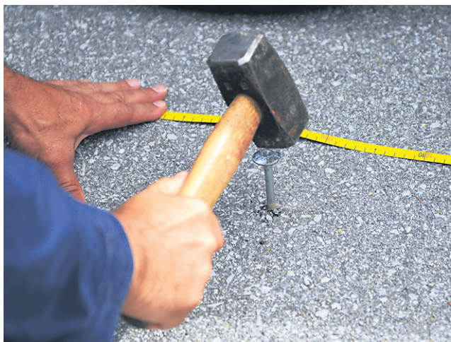
Sodni izvedenec za področje geodezije Janez Lovenjak je po sodniški izmeri in določitvi meje v tla zabila velike jeklene žeblje z napisom »mejno znamenje«.
