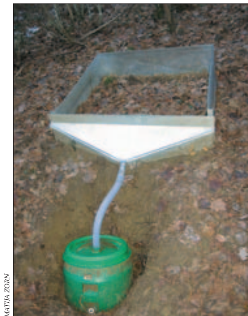
Slika 6: Zaprto erozijsko polje za merjenje erozije prsti (Zorn 2007a; 2007b).
