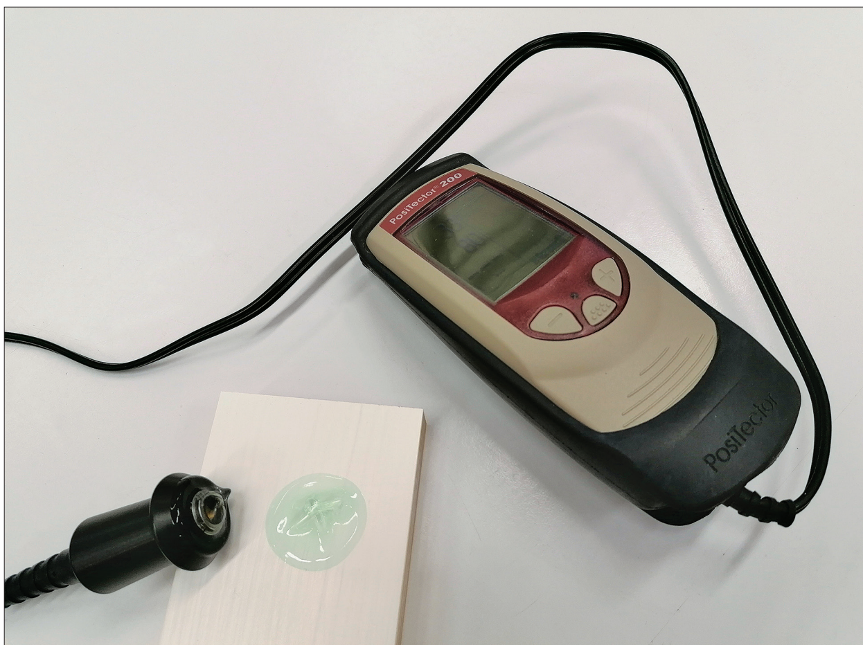
Slika 4. Ultrazvočni merilec debeline suhega filma premaza PosiTector 200.
