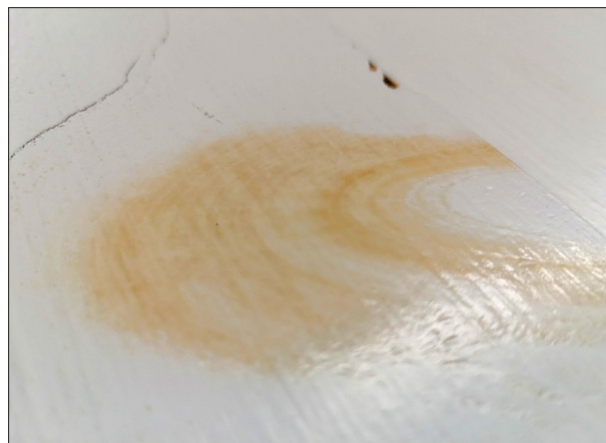
Slika 8. Obbarvanje filma premaznega sistema brez preboja lesne smole (sistem 6).
