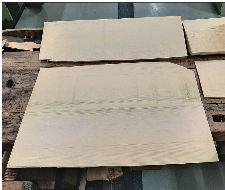
Radialno izrezani deski resonančne smrekovine, debeline 4-5 mm za izdelavo zgornje plošče kitare z zvočnico in rozeto.
