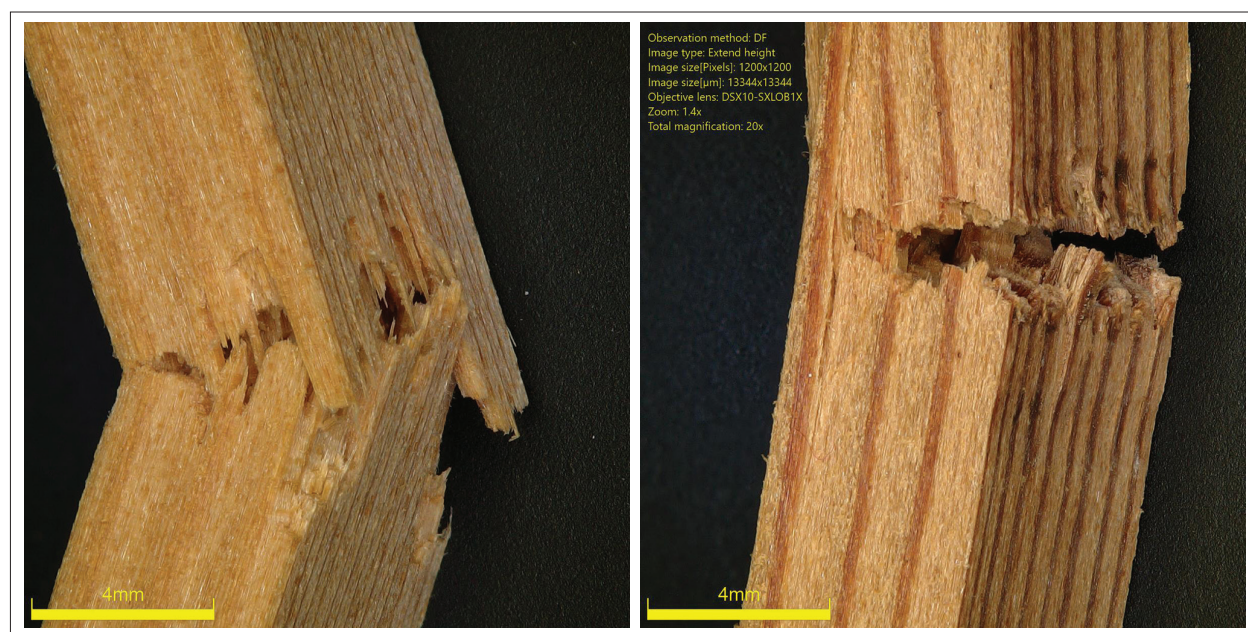
Slika 12. Prikaz žilavega loma med določanjem upogibne trdnosti (levo) in krhkega loma stare macesnovine po utrujanju (desno).
