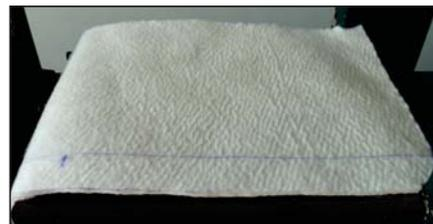
Figure 3. Composite geomembrane.
