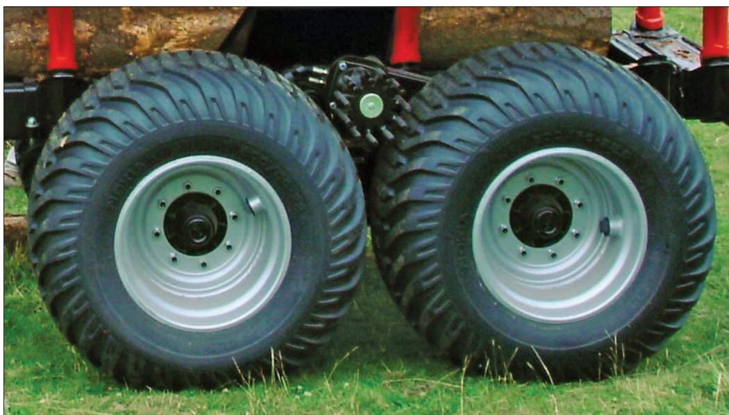
Slika 7: Pogon nihajne osi na torni prstan (Foto: B.Košir, 2006)
