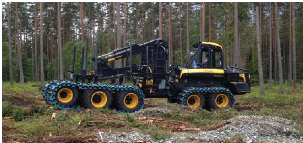
Slika 2: Prototipna, desetkolesna izvedba zgibnega polprikolničarja (foto: M. Mihelič)
