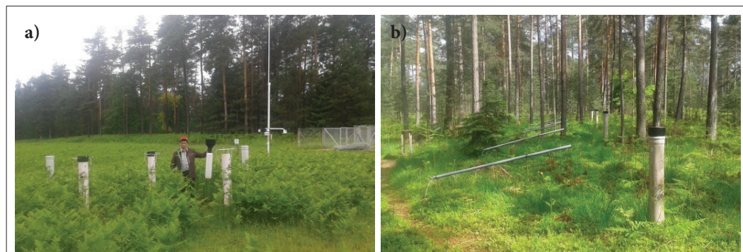
Slika 1: Ploskev IMGE Brdo za merjenje a) padavin na prostem s skrbnikom Tomažem Polajnarjem in b) linija lijev ter žlebičev za merjenje prepuščenih padavin v sestoji. (Foto: Rok Zupin, 2016)
