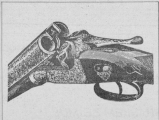
Angleška brezpetelinka Greener z značilnim zaklepom
