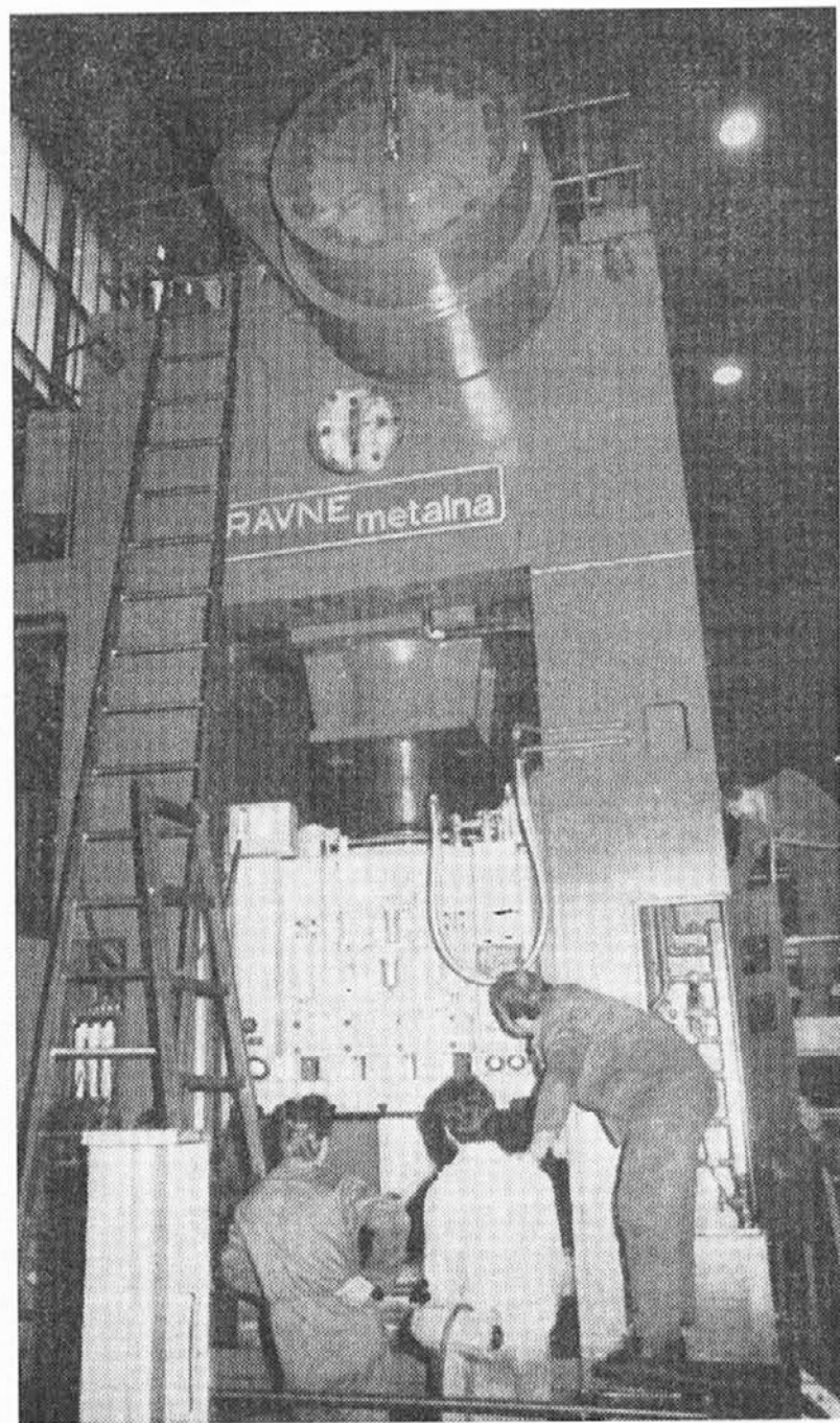
V tozdu Stroj in deli so zmontirali stiskalnico novega tipa DEE 1000. Težka je 95 ton, ima silo stiskanja 1000 ton in je vredna 19,5 milijard starih din. Naredili bodo deset takih, ki bodo vse šle v Sovjetsko zvezo. Tip te stiskalnice daje nove možnosti za prodor na tržišče.
