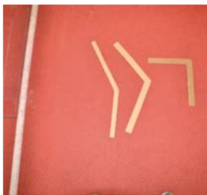
Slika 4: Šablone za določitev kotov: 150°, 120°, 90°
