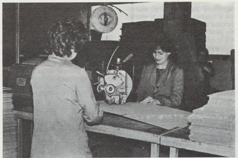
Iz proizvodnega procesa v tozdu Embalažni servis — delo pri šivanju škotel.
