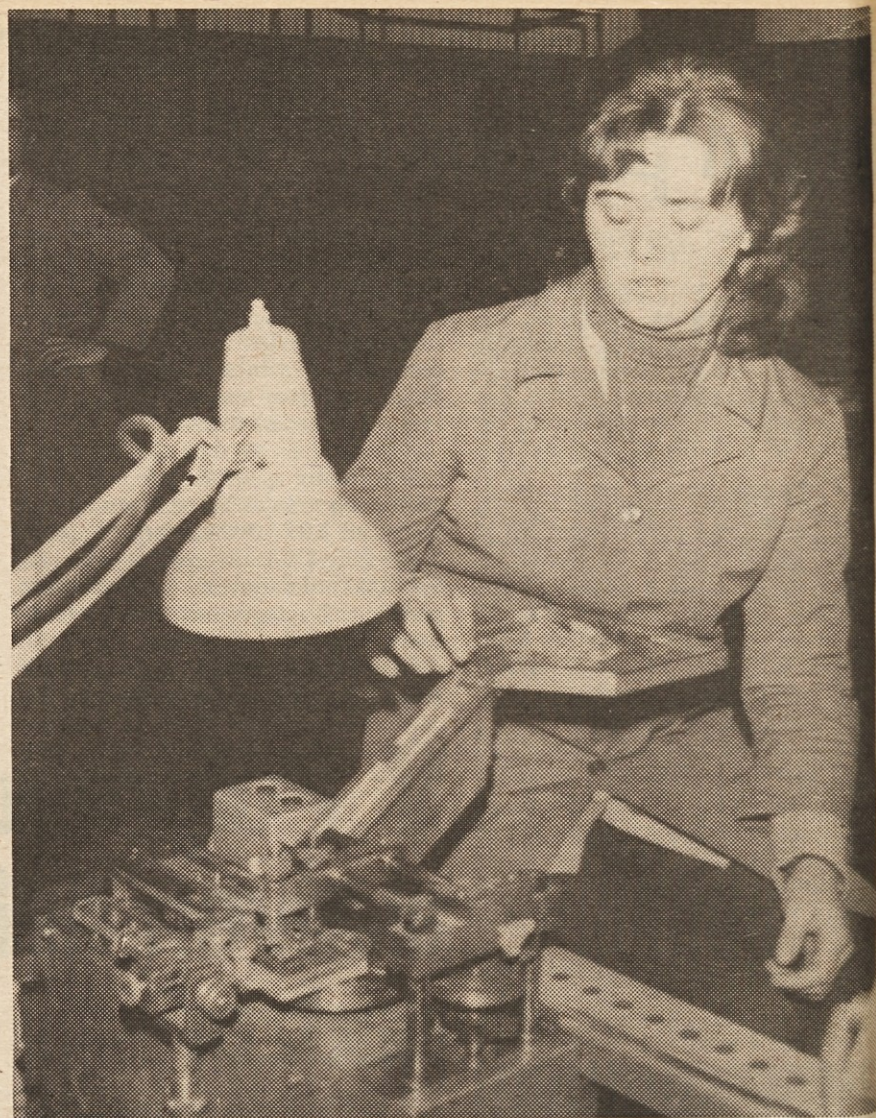
Mihaela Gnidovec dela na strojni metalizaciji kolutastih keramičnih kondenzatorjev.
